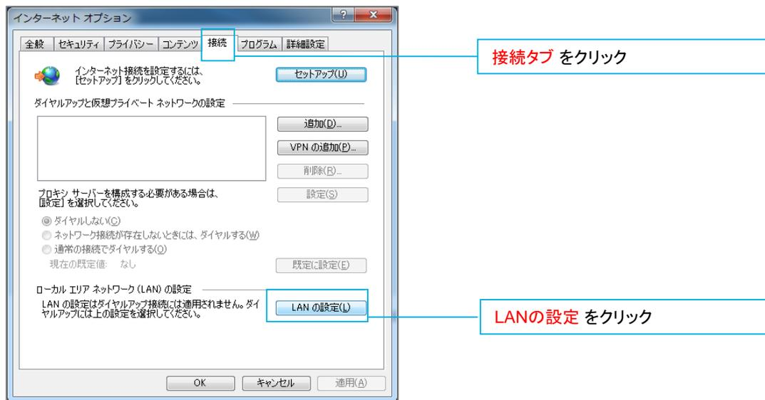
**STEP3** [ LAN にプロキシサーバを使用する ]のチェックボックスをオフにして、[OK]をクリックしてください。
